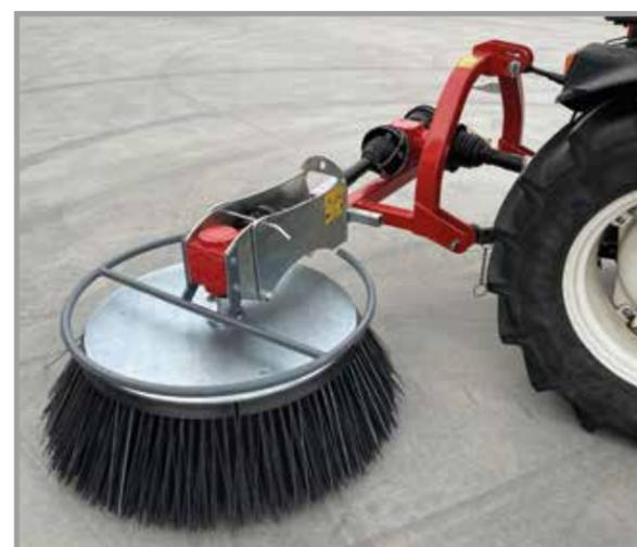
Spazzolatrice satellitare **SPT 120**, meccanica o idraulica, con setoli in pattine di acciaio 3x0.5, per rimozione sedimentazione delle banchine stradali o altro.
