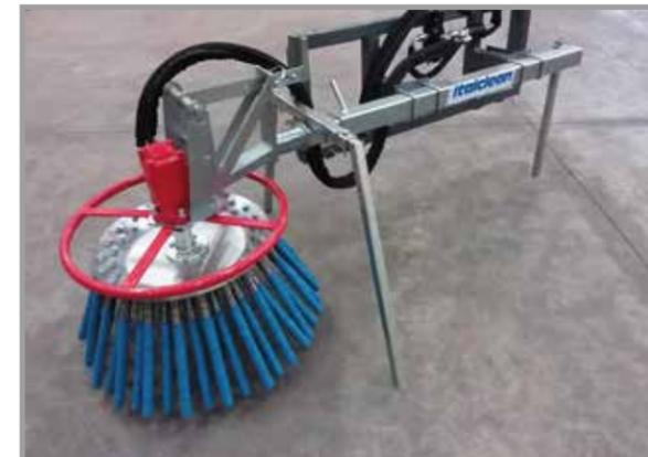
Spazzolatrice satellitare **SPT 75** nella versione idraulica, alimentata da un impianto idraulico con una portata di olio di circa 15 l/min. Attacco intermedio per skid loader e pale gommate.
