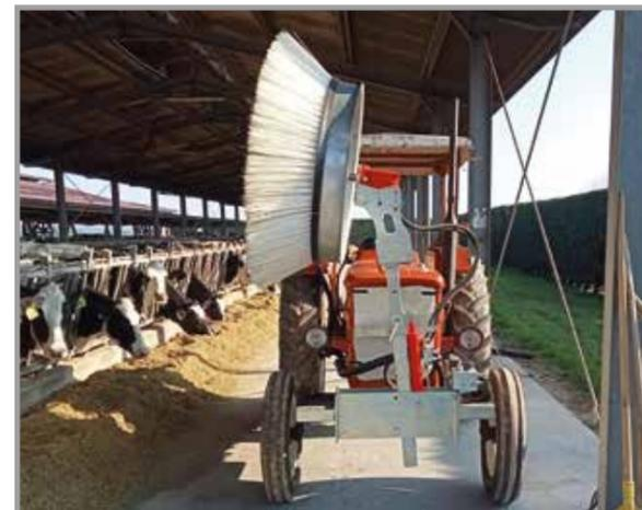
Spazzolatrice satellitare **SPT 120** con setoli in ppn, in posizione sollevata mediante cilindro idraulico. Sono necessari due impianti idraulici. La velocità di rotazione della spazzola viene regolata mediante una valvola di flusso. E' richiesta una portata di olio di circa 15 l/min.
