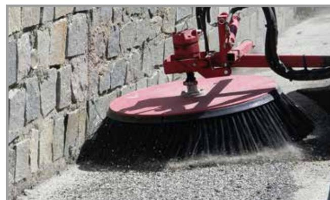
Spazzolatrice satellitare **SPT 120**, idraulica, con setoli in pattine di acciaio 3x0.5, in fase di lavoro.
