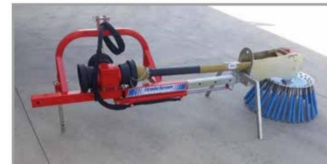
Spazzolatrice satellitare **SPT 75**, formata da cavi in acciaio rivestiti, particolarmente indicata per il diserbo meccanico. Versione meccanica con attacco a 3 punti per trattore.
