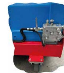
Valvola regolatrice di flusso per portate superiori a 60 l/min.
