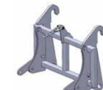
Telaio intermedio di aggancio flottante per spazzatrici fisse montate su pale gommate e telescopici.
