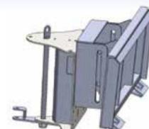
Telaio intermedio di aggancio flottante per spazzolatri angolabili montate su skid loader.
