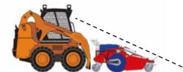
Con i 2 serbatoi acqua in polipropilene, con capacità di 50 litri cadauno, integrati nel telaio, offrono grande autonomia, mantenendo l'altezza da terra di cm. 65 permettendo un'ottima visibilità dal mezzo anche di piccole dimensioni.
