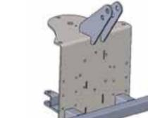
Telaio intermedio di aggancio a tre punti per spazzolatri angolabili e spazzatrici fisse idrauliche
