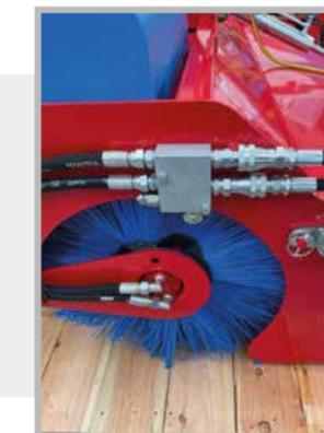
Valvola rigeneratrice di flusso (opzionale) e innesti rapidi per sgancio contenitore di raccolta, mantenendo il funzionamento della spazzola centrale per operazioni di spazzolamento, anche con lama sgombraneve montata.
